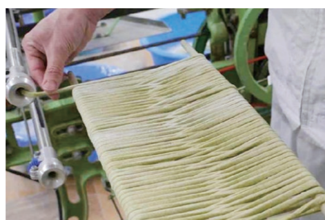
アオサノリ粉末を練り込んで手延べにより製麺する工程(一部)
